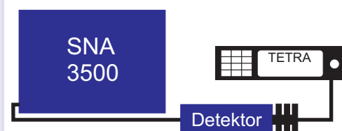
Mesure de puissance d'un émetteur-récepteur avec le SNA 3500 et le détecteur de puissance
