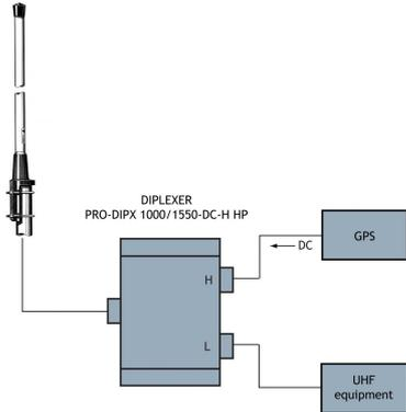
Alternativement, DIPEXEUR DIPX 1000/1550-DC-H peut être utilisé. Le filtre est à commander séparément.
