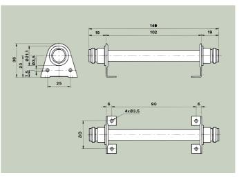
Le LPZ 960 est utilisé pour empêcher les interférences créées par la production excessive d'harmoniques venant d'émetteurs dans la bande des 900 MHz. Lors de l'atténuation, le filtre réduit l'amplitude d'harmoniques et les empêche d'être rayonnées par l'antenne.
